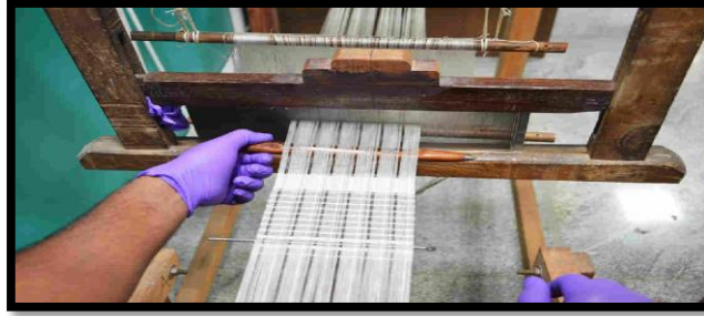
الشكل (10) نول يدوي يستخدم لنسج شرائط الحرير، والتي كانت تستخدم كمستشعرات الجلوكوز
